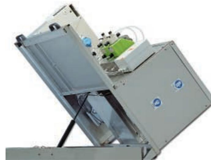
Grazie ad un'apertura pneumatica è possibile ispezionare l'interno dell'impianto. Le pompe dosatrici regolano la quantità degli additivi.
